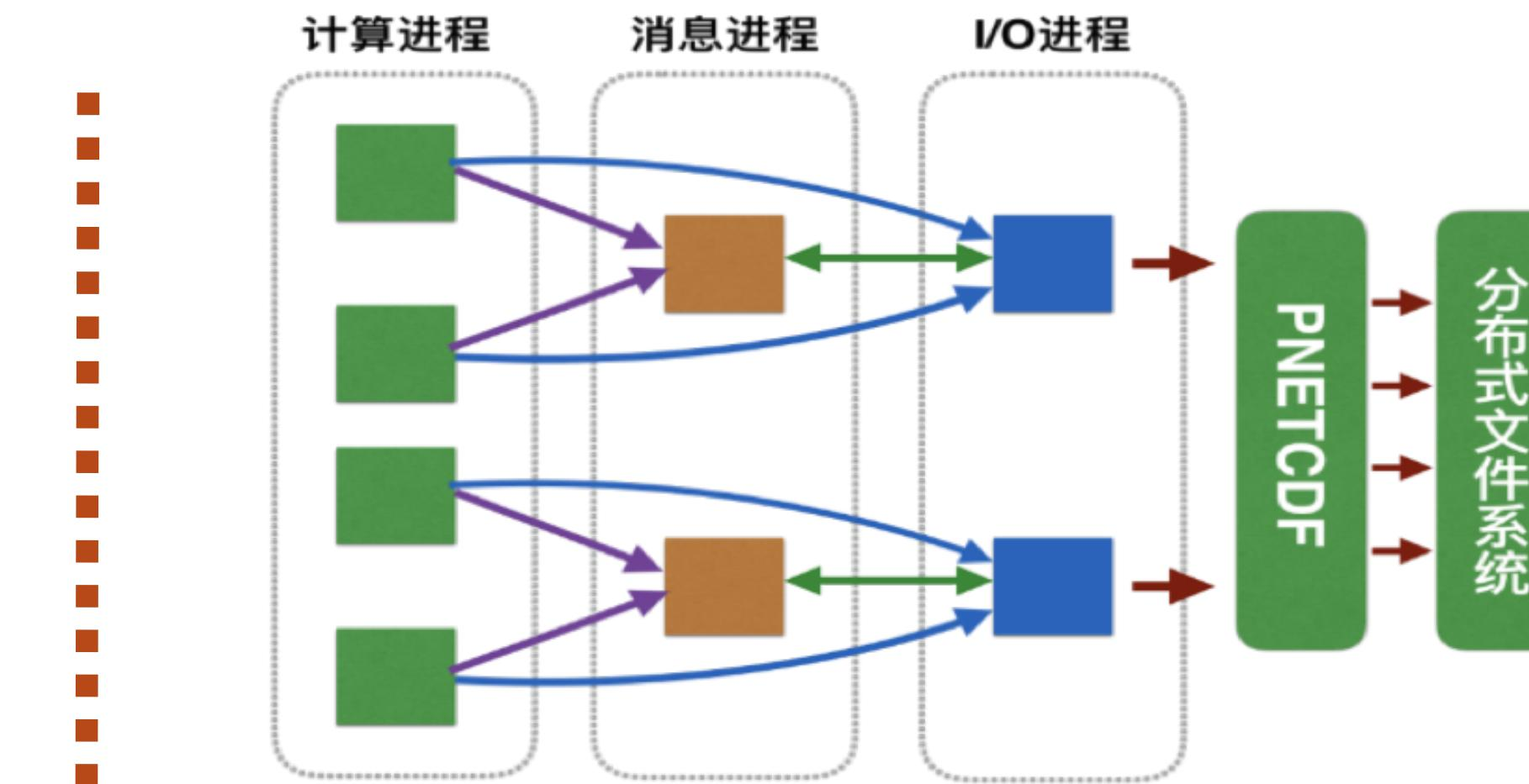
**(1) 生成请求：**计算进程负责模式的计算过程并生成I/O请求消息，然后将消息发送给消息进程。
