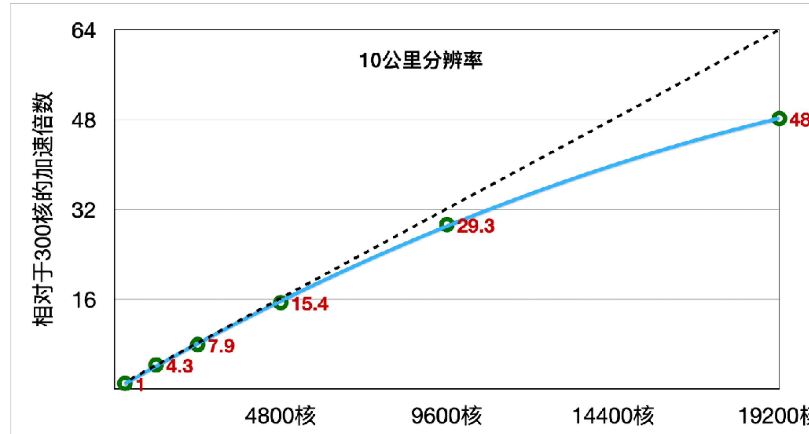
使用算子库重构**CAS-ESM**海洋分量模式**LICOM3**, 19200核相比于300核加速48.2倍,
