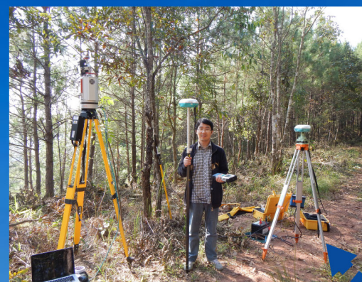
图4 黄华兵副研究员在野外利用地基激光雷达采集森林的三维影像
