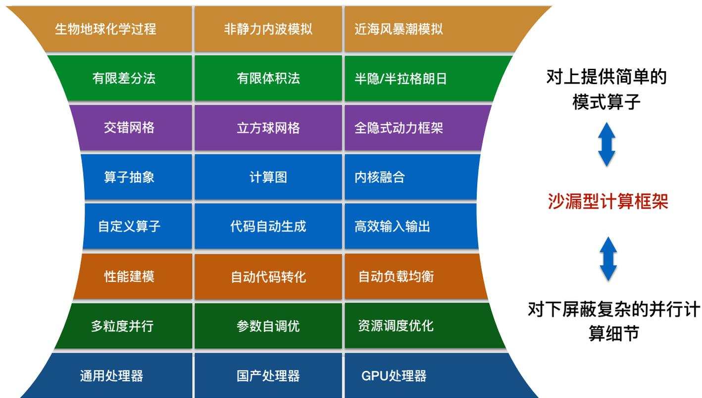
关键思路：以流场和算子为载体，对流场变量进行整体计算，在算子内部实现自动并行
